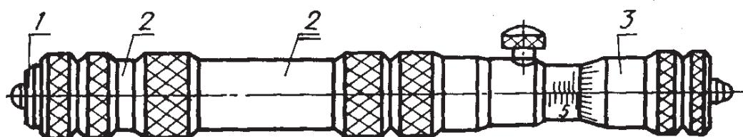
1—измерительный наконечник; 2—удлинитель; 3—микрометрическая головка
