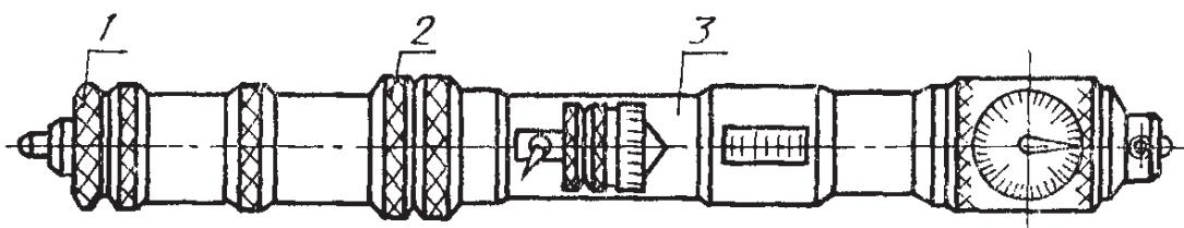
1—измерительный наконечник; 2—удлинитель; 3—микрометрическая головка с индикатором
