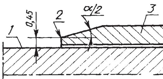
1—поверхность стебля; 2—измерительная кромка; 3—барабан
