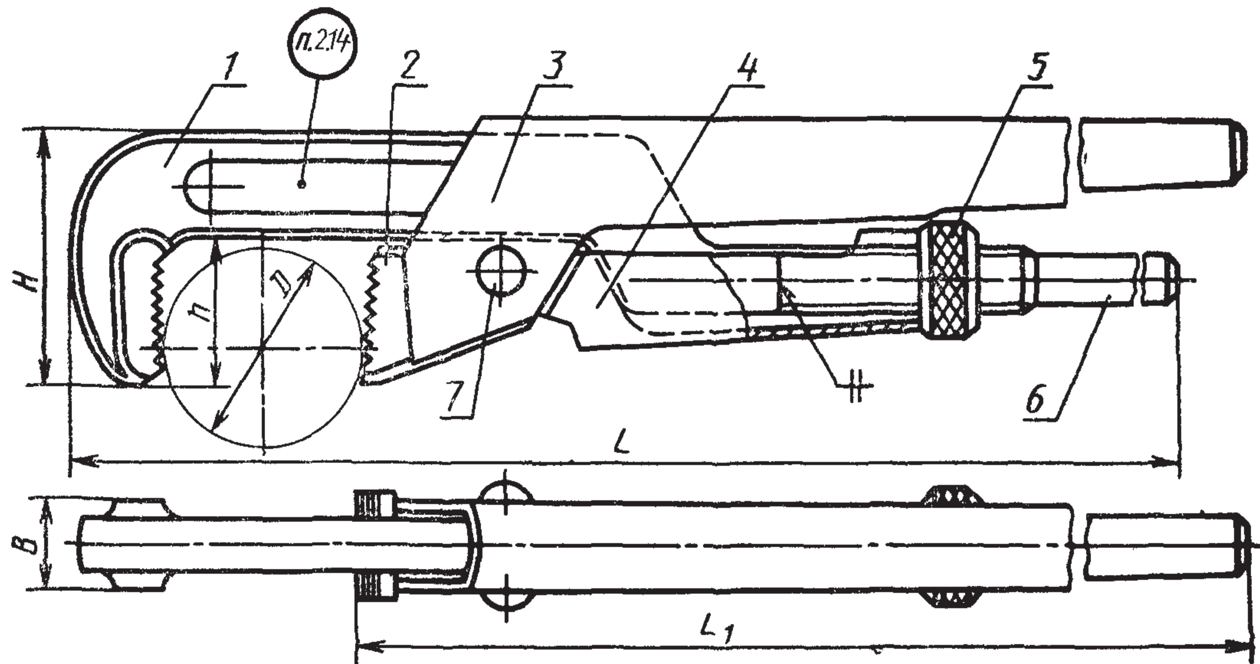
1 — подвижной рычаг; 2 — губка; 3 — неподвижный рычаг; 4 — поводок; 5 — гайка; 6 — рукоятка подвижного рычага; 7 — ось (заклепка по ГОСТ 10299—80).
