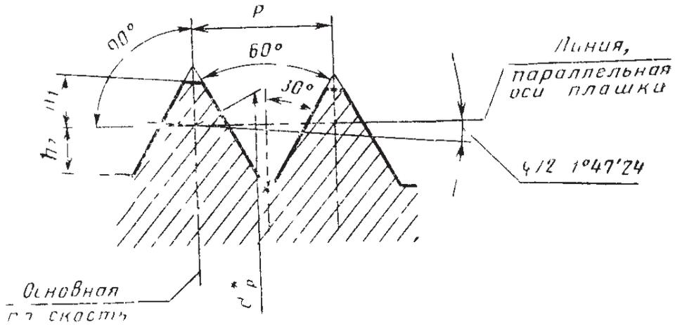
Профиль резьбы чистовых метчиков для трубной конической резьбы по ГОСТ 6211—81
