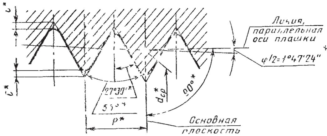
\* Размеры обеспечиваются инструментом.
