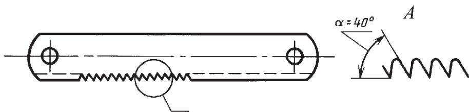
Передний угол  $\gamma = 0^\circ$ .
